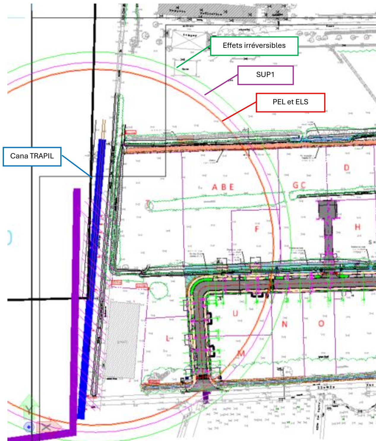
Figure 4 : Zones d'effet générées par la canalisation TRAPIL en cas de brèche 70 mm et SUP 1
